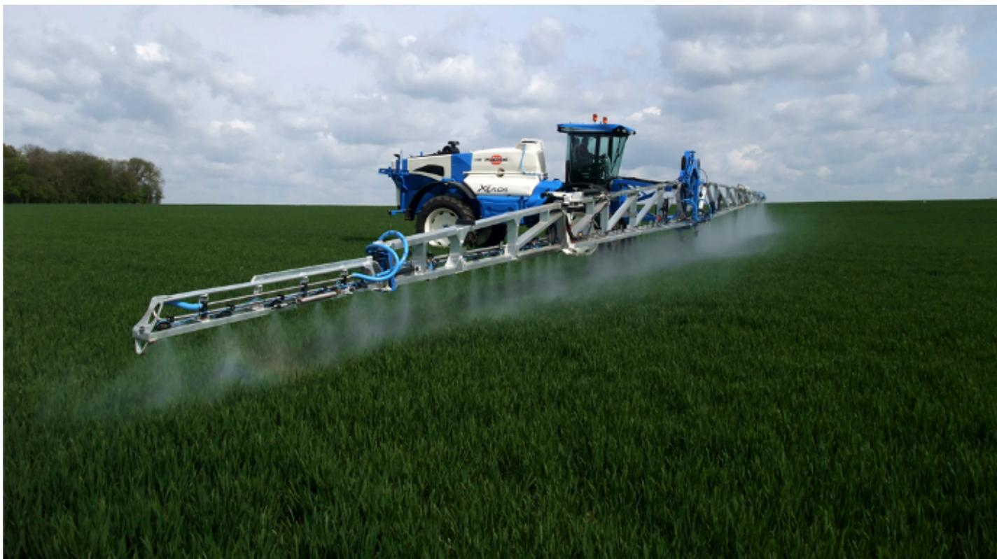
Le Xénon peut recevoir une cuve de 4.300 ou 5.200 litres, associée à des rampes allant jusqu'à 50 m. (©Matrot)
